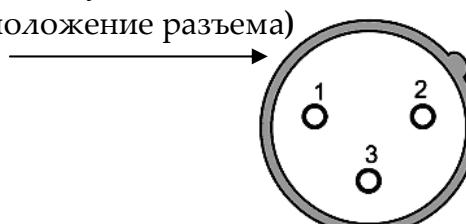
Распайка входных и выходных XLR разъемов стандартная:
